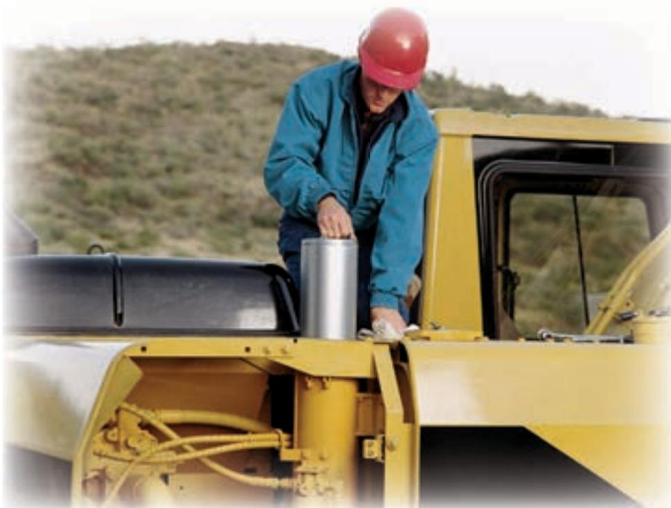
Lors de la dépose d'un organe mécanique, obturez tous les passages de fluides.
