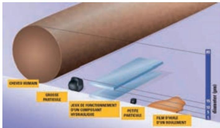
L'usure par abrasion des composants du circuit d'injection de carburant et de ceux du circuit hydraulique est particulièrement insidieuse : les jeux de fonctionnement augmentent progressivement, ce qui produit une baisse lente et insensible des performances.
